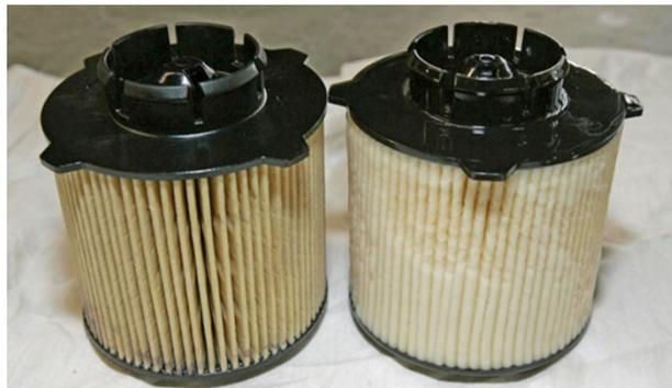
Verstopfte Treibstofffilter durch kristallisierte Dieselkomponenten
